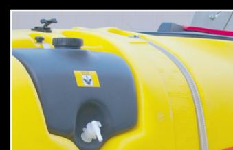
Cisterna con doble indicador de nivel: uno frontal (visible desde el tractor) y otro lateral. El desagüe mediante tirador sobre el depósito proporciona una operación cómoda, limpia y segura.
