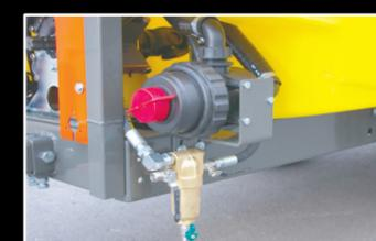
Líneas con latiguillos de alta presión, que evitan pérdidas. El sistema de filtración, por etapas, protege los componentes del circuito y a la vez garantiza una fina pulverización.
