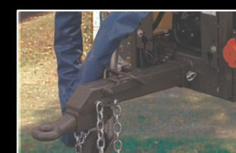
La lanza extensible permite adaptar la máquina a la geometría del tractor. La lanza dispone de apoyo escamoteable para sujetar la toma de fuerza, cuando esta se desengancha del tractor.
