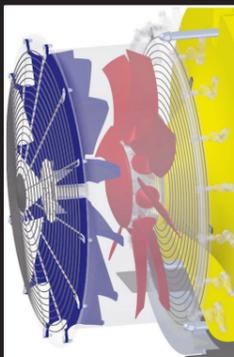
La tobera del ventilador, en acero inox., está fabricada en perfil de revolución aerodinámico, que proporciona gran caudal de aire a un coste de operación mínimo. La hélice fija de la entrada de la tobera corrige el flujo (izquierda-derecha). Incorpora recuperación del aire generado en la parte inferior; esta corriente se re canaliza, reforzando el flujo donde se necesita.
