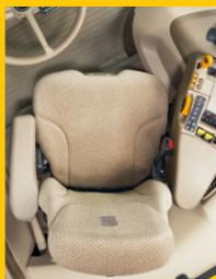
**Asiento del operador giratorio, con suspensión neumática**
