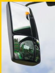
**Espejos retrovisores telescópicos de gran angular con ajuste eléctrico y desempañado**
