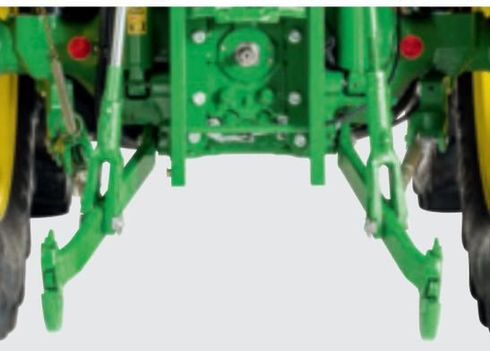
Enganche lo que necesite para trabajar. Fabricado para manejar los aperos más pesados, el resistente elevador trasero del 5M tiene una capacidad máxima de elevación de hasta 4.440 kg (capacidad máxima de elevación en los ganchos).
