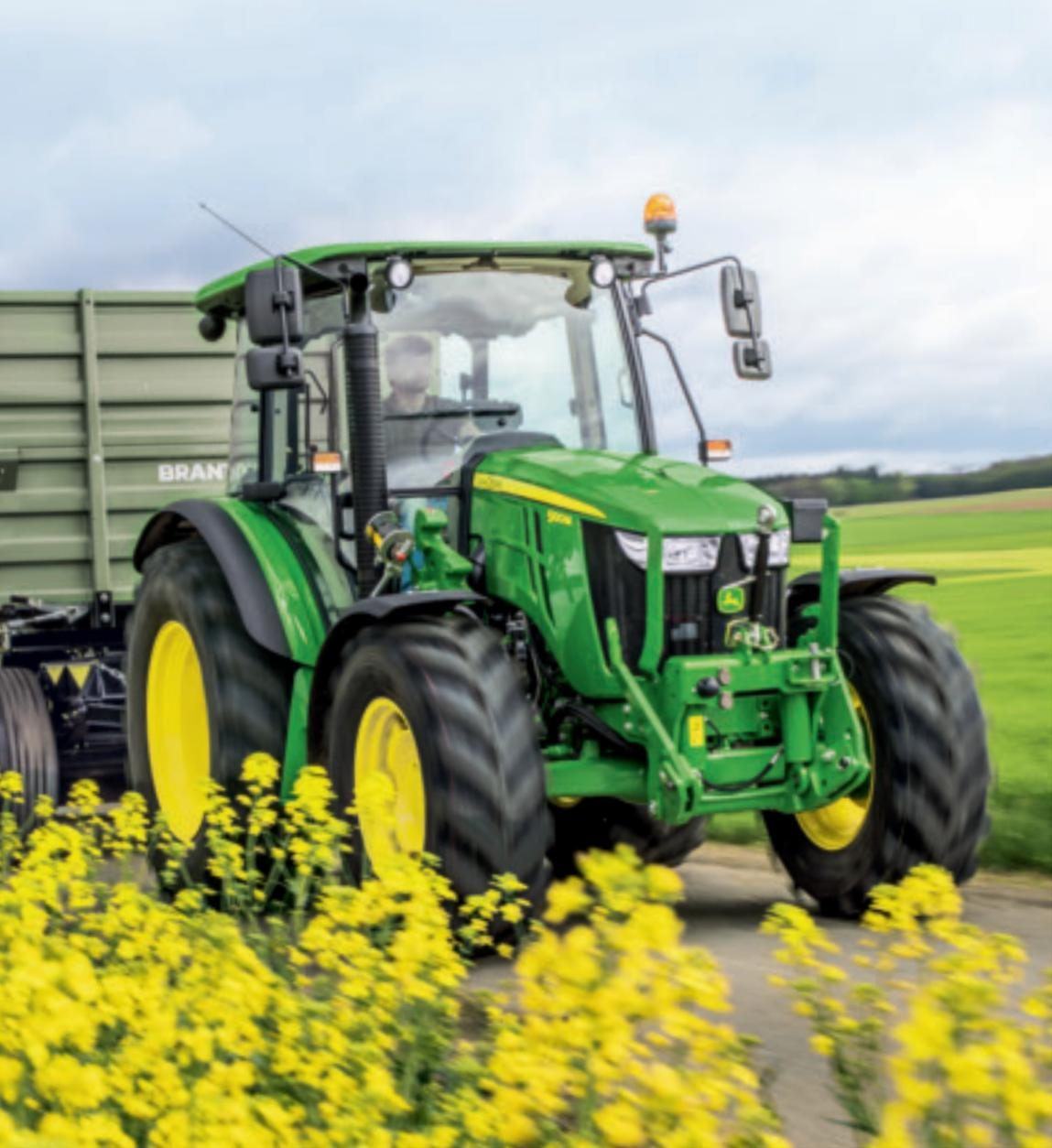
No requiere aditivos. Combinando la tecnología de Recirculación de Gases de Escape Refrigerados (EGR) con un enfriador intermedio y un Filtro de Partículas Diésel (DPF), el motor cumple la normativa de emisiones Fase III B sin necesidad de aditivos.
